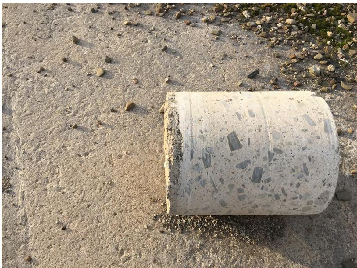
Bild 30: Bohrkern der vorh. Oberflächenversiegelung mit Anhaftungen von Müllbeton
